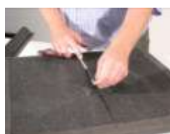
Biegungen: Einschneiden, Knicken und Verkleben der Schnitte
