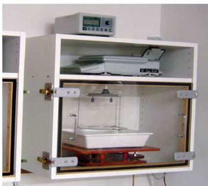
Abb. 2.7: Automatisierte Bestimmung des Wasseraufnahmekoeffizienten (links: Probenhalter mit Waage, rechts: schematischer Kurvenverlauf) am Bauphysikalischen Forschungs- und Entwicklungslabor
