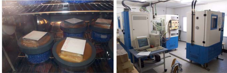
Abb. 2.9: Bestimmung des Wasserdampfdiffusionskoeffizienten (links: Behälter zur Probeninstallation im Klimaschrank, rechts: Klimaschränke) am Bauphysikalischen Forschungs- und Entwicklungslabor
