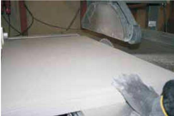
Maßgenauer Zuschnitt der Kernplatte aus pyrogener Kieselsäure
