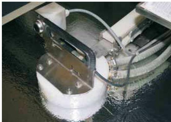
Zweite Innendruckmessung durch Laserabstandsmessung - jedes Bauteil
