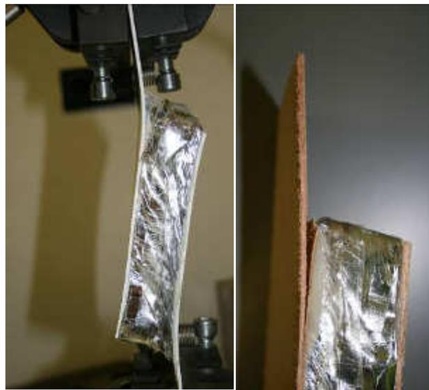
Prüfung der Verklebung bis zum Materialbruch
